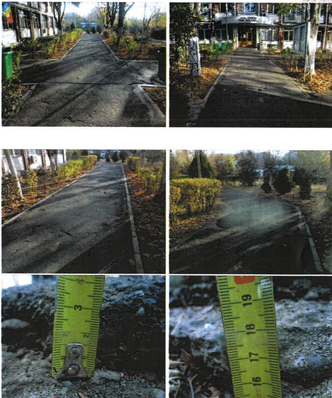
Foto 19-24 Imagini cu traseul cercetat și grosimea sistemului rutier în S1
